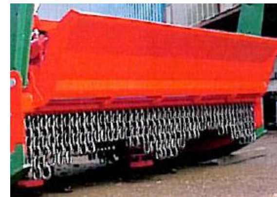
Vista posterior de un modelo de desbrozadora de cadenas con tapa hidráulica abatible.
