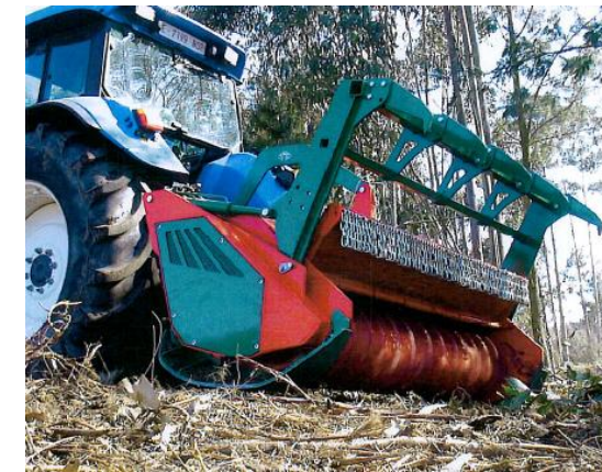
Trituradora forestal de martillos fijos implementada en tractor forestal llevando a cabo trabajos de desbroce. Desbrozadora de cadenas forestales:
